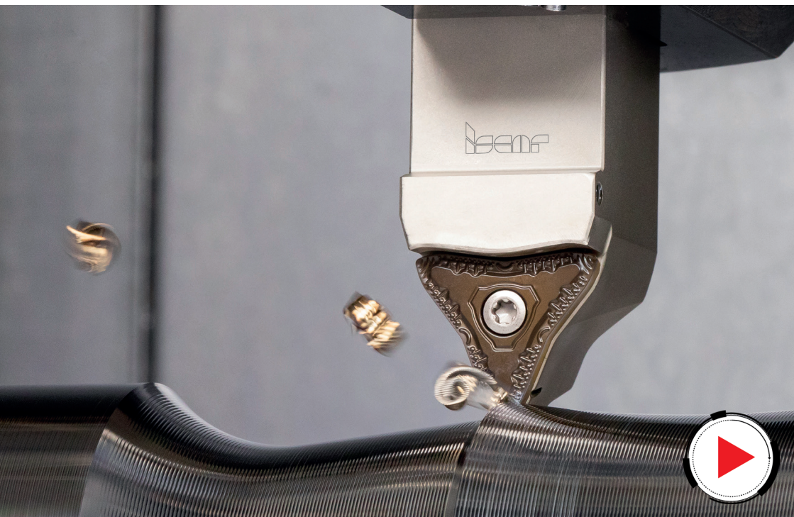
Bild 3 QUICK-T-LOCK Q3 MCMT-skär är även det konstruerat för svarvning i flera riktningar. Till skillnad från Q6 MNMG-skäret är detta skär ett enkelsidigt positivt skär med 3 skäreppor
