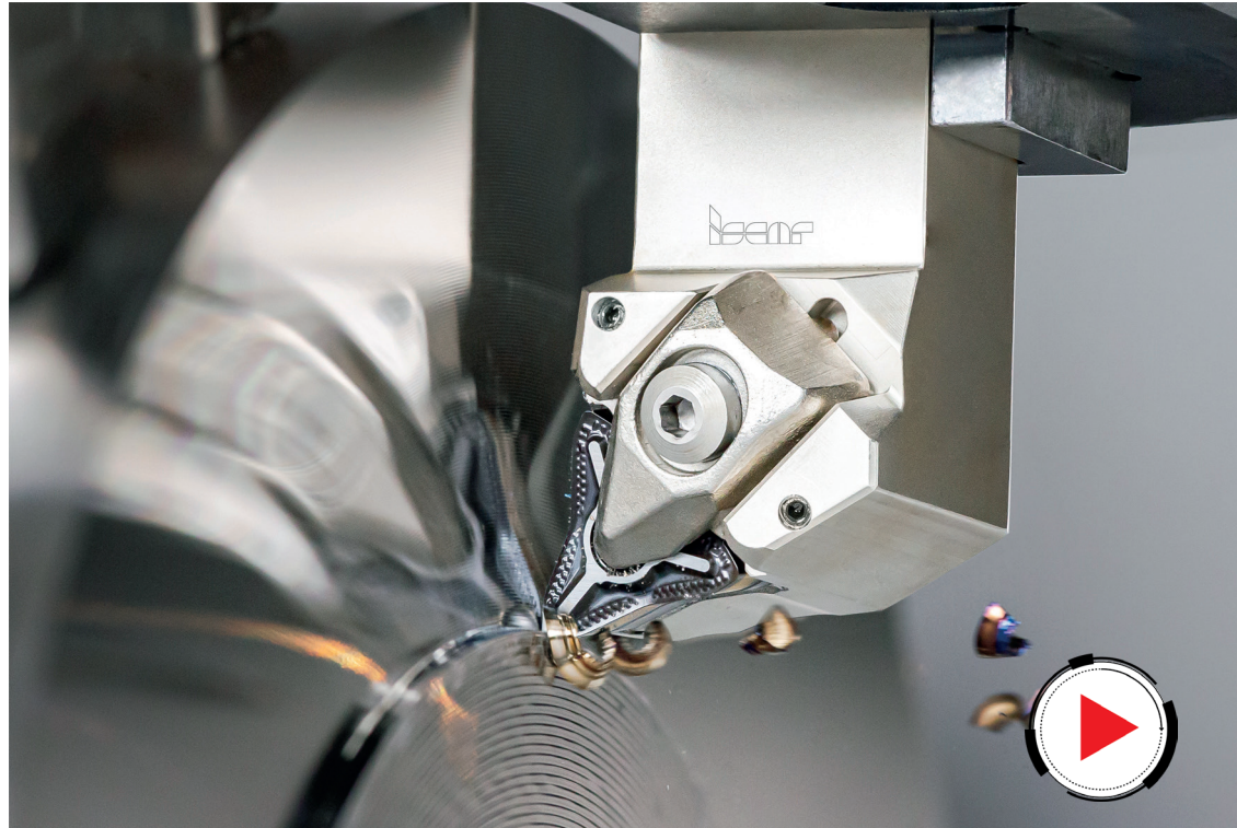
Bild 2 QUICKTURN Q6 MNMG-skär med 6 skäreggar klarar bearbetning i flera riktningar
